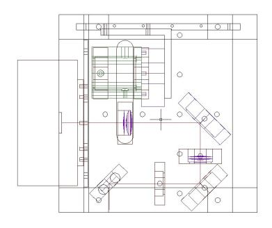
図 2: SH/PCS 試験ベンチレイアウト – 光軸面に投影
