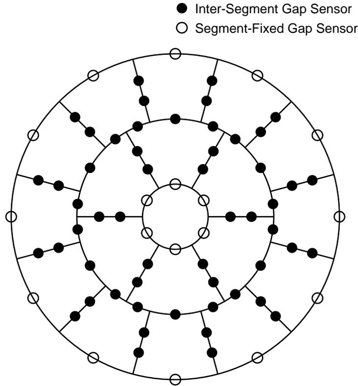
図 1: ギャップセンサー配置場所
