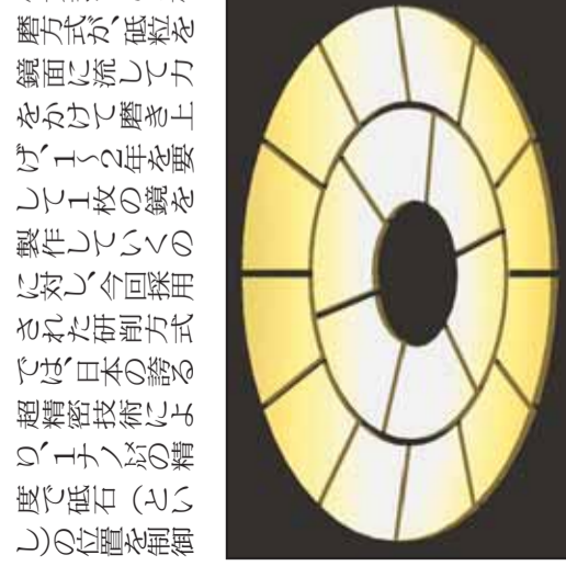
写真上=主鏡を構成する18枚の鏡。チタニウムの精度で位置合わせ、角度合わせを行う(京都大提供) 写真下=トランプ構造による、軽量化は将来構想となる30メートル級には不可欠だ(京都大提供)
