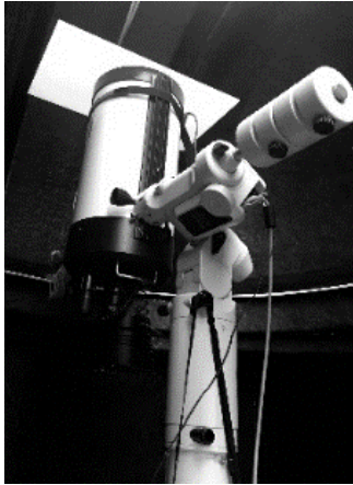
Fig. 2. 岡山理科大学天文台 23.5cm 望遠鏡 (白い板はFFを撮るためのディフューザー)
