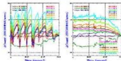
前回の補正係数と同じ係数で補正を続けた所、始めの4日間程度は大体補正できましたが、後半に大きく変化が生じた。湿度の影響を受けて変化したようなので、環境パラメータに対する最小2乗係数を再度調べてみる。
