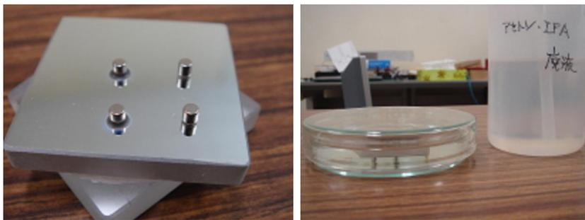
浸してから3時間後に確認した所、粉末+液体タイプの接着剤で固定したもの1つ以外は剥離していた。残った1つは24時間浸しても剥離しなかった。剥離後の状態は、ゲル+ゲルタイプのものは綺麗に取れているのに対し、粉末+液体タイプのものはアルミが侵食されていた。
