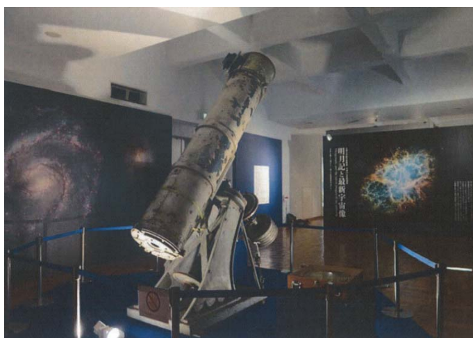
写真 13 参考；かつて沼津香貫山天文台にあった 46cm 反射赤道儀 (カルバー46 センチ) 2014 年、京都大学での復元展示
