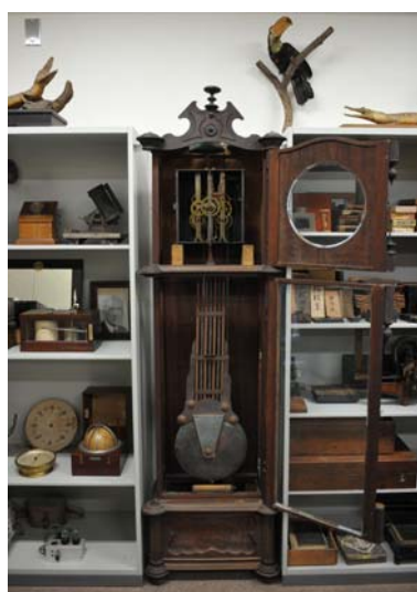
大時計の本体を組み込み設置した状態。左は扉を開けている。まだ文字盤、針ははずしてある。
