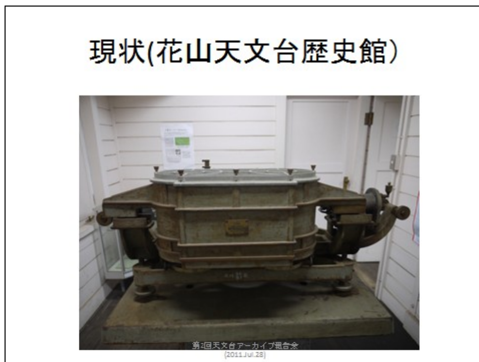
図 4 : アスカニア製スペクトロヘリオグラム全景
