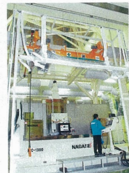
ナガセインテグレッタスが開発した、レンズ加工機「N-C-1300」。専用の建屋いっばいに鎮座する巨大な工作機械だが、10ナノメートル単位で繊細に動く。
