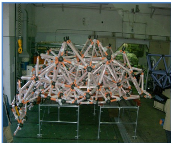
図 5.23 仮組中の主鏡セルトラス。
