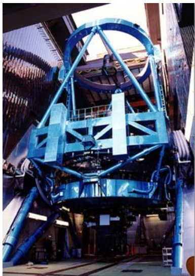
図 5.9 すばる望遠鏡の架台部。 写真中央の四角の枠体がセンタ セクションと呼ばれる部分。
