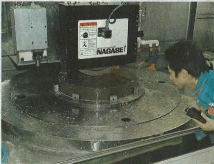
1ナメートル単位の加工が可能な研削機。下の台が回転し、上の砥石（といし）が動きながら望遠鏡の分割鏡を削る＝岡市武芸川町跡部のナガセインテグレックス社工場
