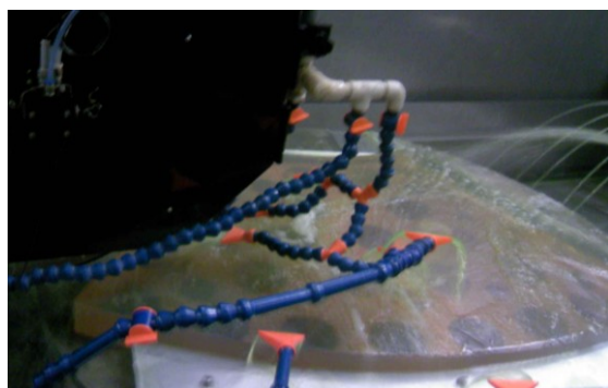
図 2.1 研削による反射鏡の製作。扇形の鏡を、左の黒いボックス中で高速回転している砥石で削って、高精度面に仕上げていく。
