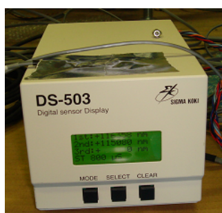
図 7.1 新型コントロールボックスの外観。ボックス上部のアルミテープは温度センサーを取り付けるためのもの。
